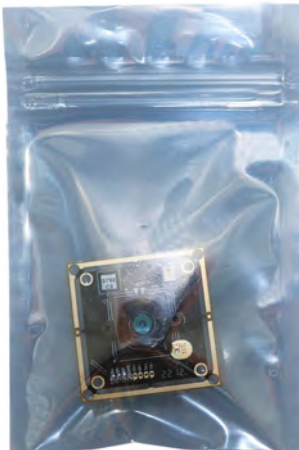
Scellez le plateau avec un sac antistatique
